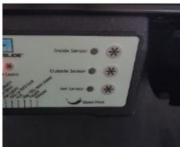
コントロールパネル右に三つの※じるしのスイッチがあります。一番上のスイッチを押してください。押して、ドアが自動で動き、ふたたび閉じれば設定完了です。
