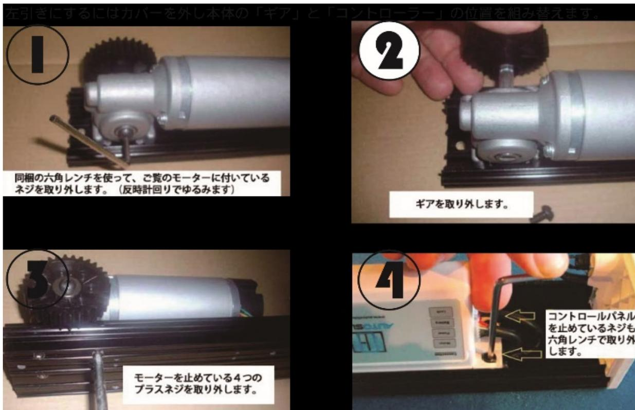
3のとき、ギアを再度、逆側から挿入し、付属ネジを六角レンチできつく締めなおしてください。
