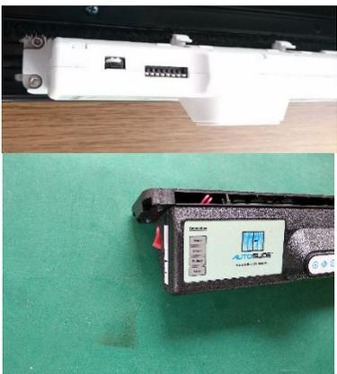
ディップスイッチの方向を必ず確認し、ドアを閉め、オートスライド本体の左にある赤い主電源スイッチをいれてください。ゆっくりとオートスライドが動き出し、自動で設定します。
