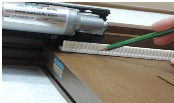
上枠からレールの下部まで52mm以内としてください。それ以上だとギアが空転してしまいます。レール接合部はビスをとめることで結合します。(付属の接合金具は基本的には使用しません)
